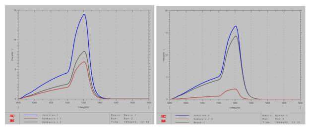
Nelle precedenti immagini sono riportati gli andamenti temporali delle portate in ingresso ed in uscita ai principali nodi (Junction) dove gli idrogrammi in uscita dai sottobacini o dai rami (reach) di propagazione vengono sommati. Nel seguito un esempio per il bacino 5 di precipitazione con perdite iniziali pari a 7 mm e di idrogramma di piena conseguentemente prodotto. (tempo di ritorno di riferimento 200 anni).
